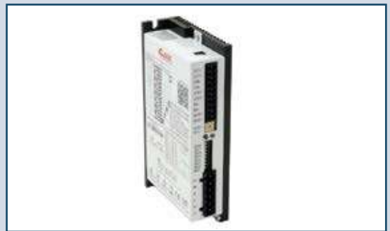
Azionamenti vettoriale Step/Dir, da 12Vdc a 230Vac
