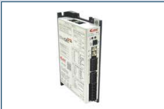
Azionamenti brushless alta tensione (85-265Vac) e bassa tensione (12 - 48Vdc)
